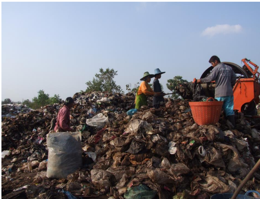
ขั้นตอนที่ 6 การร่อนขยะด้วยเครื่องร่อนหลังจากขยะถูกบำบัดแล้ว 7 - 9 เดือน
