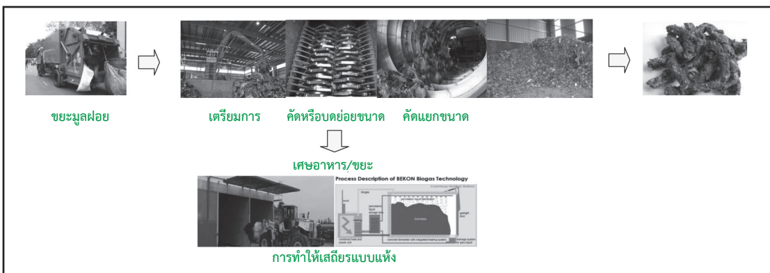
รูปที่ ข-2 กระบวนการบำบัดโดยการทำให้เสถียรแบบแห้ง
