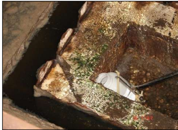
รูปที่ ๒๐ การเก็บตัวอย่างน้ำทิ้งที่ไหลผ่านฝายน้ำล้น (weir)
