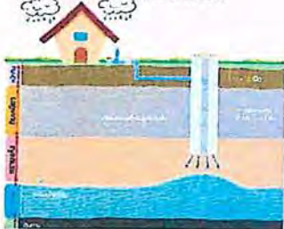
ระบบเติมน้ำฝนจากหลังคาผ่านบ่อวงคอนกรีต
