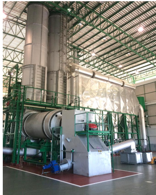
ห้องที่ 2 เาเผาวัน ต้องมีอุณหภูมิ \geq 1,000^{\circ}\text{C}
