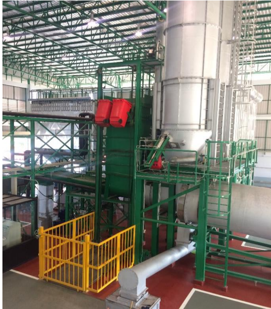
ห้องที่ 1 เาเผามูลฝอยติดเชื้อ ต้องมีอุณหภูมิ \geq 760^{\circ}\text{C}
